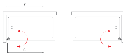
SCREEN MINI - universalus montavimas KAIRĖJE arba DEŠINĖJE
