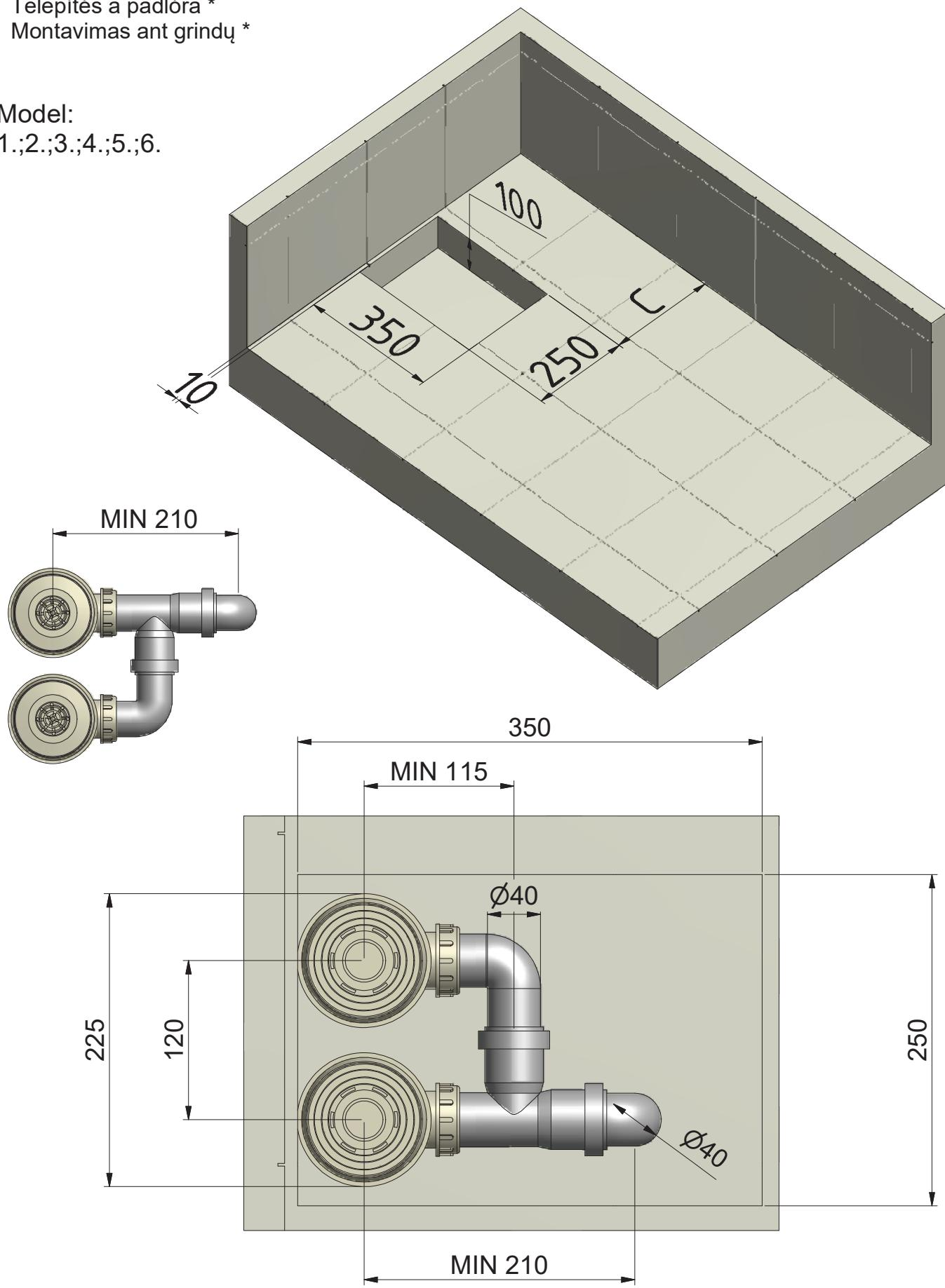
stavební připravenost \* construction preparation \* Aufbau-Vorbereitung \*
